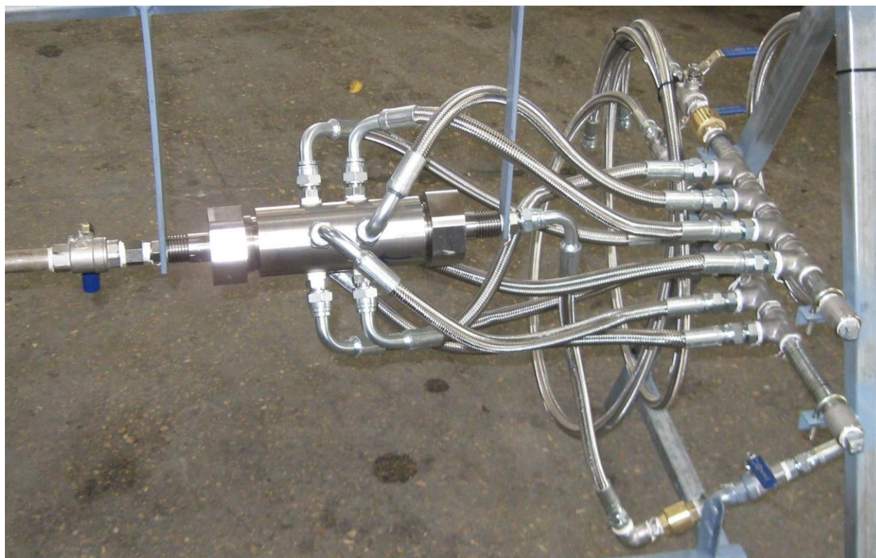
Рис.4. Мультисистема, производительностью в 1000 литров в час
